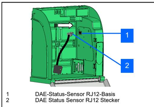
• Der AED-Zustandssensor wird am Sockel angeschlossen und dann auf seine Basis gesetzt, die wiederum am AED befestigt wird.
