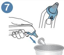
**7** Entfernen einer gebrauchten Schutzkappe durch Drücken der Schutzkappen-Abwurf taste.
